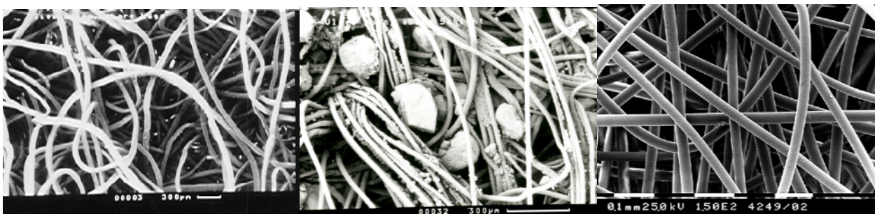
Abbildung 3 REM-Aufnahmen der aufgegrabenen Filtervliesstoffe der Dränmatten der Deponien BU (links) und VI (Mitte) sowie eines fabrikneuen Filtervliesstoffes (rechts)
